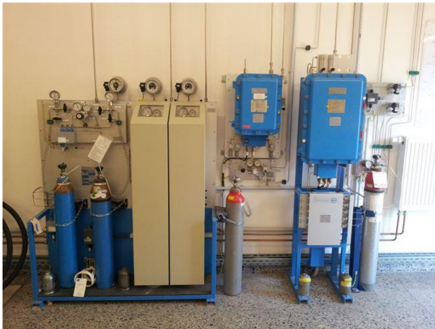
Abbildung 11: Prozessgaschromatograph (PGC) [Messwerk mit Flaschengestell]
